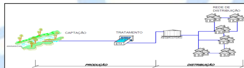
FIGURA 1 – ESQUEMA SIMPLIFICADO DE UM SISTEMA DE ABASTECIMENTO
